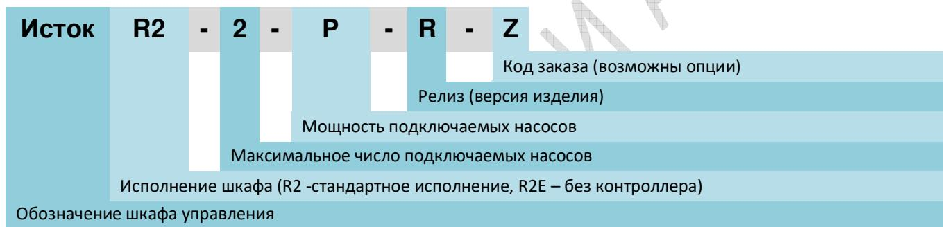
Например, Исток R2-2-5,5-009R2+Z710 – шкаф управления насосами «Исток» исполнения Исток R2 с числом подключаемых двигателей до 2х и мощностью каждого 5,5 кВт, код заказа 009R2 с опцией Z710 (степень защиты IP54). При заказе шкафа на основании данного руководства кодом заказа принять обозначение релиза:
